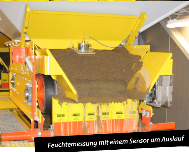
Optische Feuchtemessung der Zuschlagstoffe mit „Gleit“-Vorrichtung
